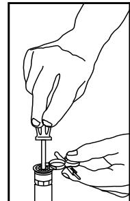
Радиус не следует уменьшать более чем на 25%. В заводских условиях форсунка отрегулирована на максимальный радиус.
