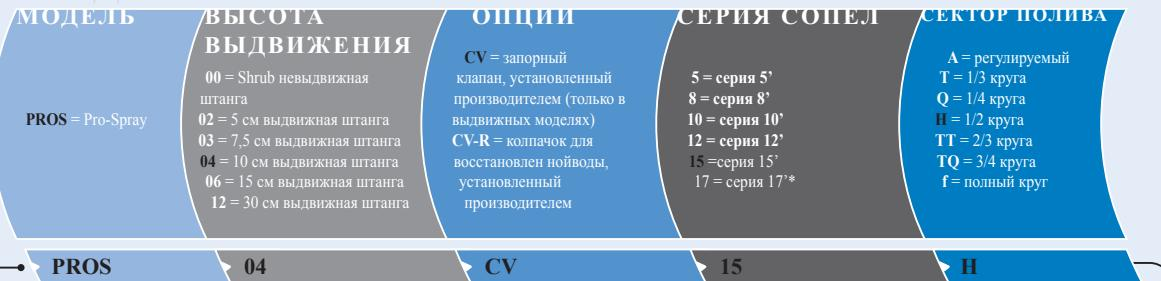
Примечание: Корпуса и сопла продаются по отдельности. Также совместимы с соплами баблер и специальными соплами Hunter. Для серии 17 в наличии имеются только сектора Регулируемый, 1/2 круга и 1/4 круга. Для выдвижных штанг 5 см или 7,5 см нет в наличии моделей CV и CV-R..
