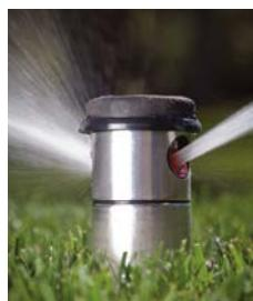
Модель с противопоставленными соплами обеспечивает отличное распределение воды. Основное и вторичное сопла расположены на противоположных сторонах башенки, и полив осуществляется в противоположном направлении по мере вращения дождевателя, чем достигается отличное покрытие в ближней к дождевателю и средней части сектора.
