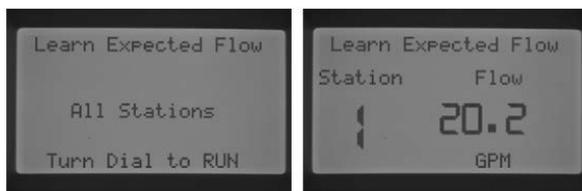
На дисплее «Learn Expected Flow» также будет отображаться информация в случае возникновения какой-либо ошибки программирования. Если значения продолжительности рабочих циклов зон не были запрограммированы в режиме экрана «SET STATION RUN TIMES», на дисплее контроллера в режиме «LEARN EXPECTED FLOW» появится уведомление «No Runtime».
