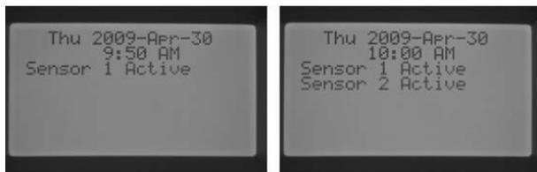
Если обходной переключатель датчика дождя перемещается в положение «Вурасс» (обход), лампочка индикации состояния датчика системы потухнет. Любой датчик Click, подключенный к котроллеру, будет проигнорирован, и полив возобновится в нормальном режиме.
