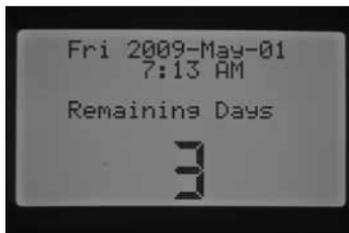
3. Верните переключатель в положение «Run». В этом режиме на дисплее отобразится количество дней для программируемого начального отсчета. В этом режиме на дисплее будет отображаться обратный отсчет дней, с
